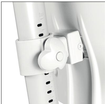
Для регулировки высоты спинки поверните фиксирующий барашек против часовой стрелки. Ослабьте барашек, затем поднимите или опустите спинку на нужную высоту. Затем снова затяните барашек, поворачивая его по часовой стрелке.
