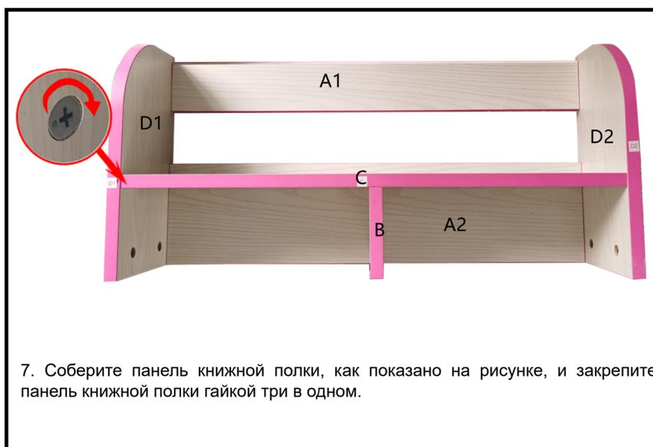
7. Соберите панель книжной полки, как показано на рисунке, и закрепите панель книжной полки гайкой три в одном.
