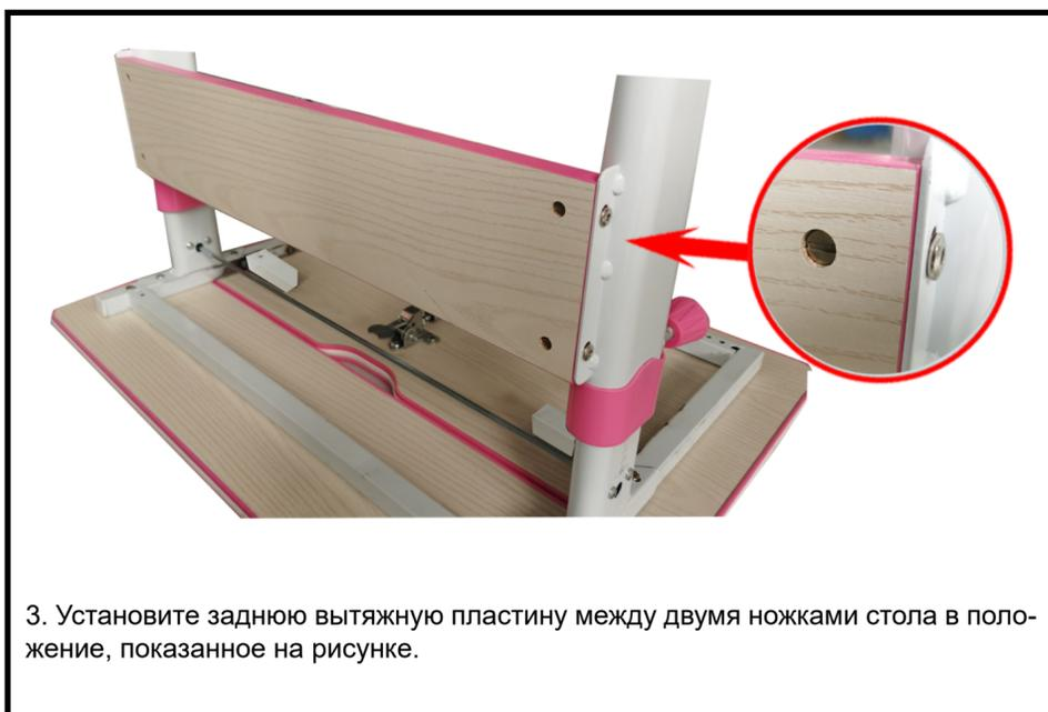
3. Установите заднюю вытяжную пластину между двумя ножками стола в положение, показанное на рисунке.
